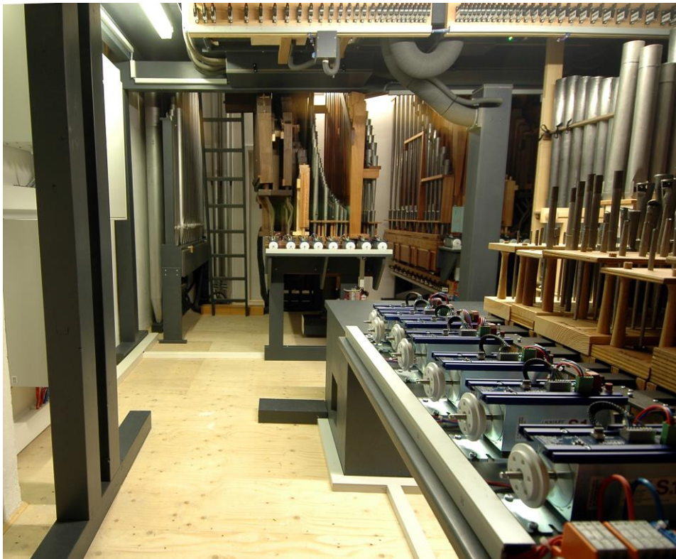
Blick ins Untergehäuse der Orgel: Hinten stehen die Pedalwindladen, im Vordergrund rechts sieht man das Echowerk mit den zugehörigen Schleifenzugmagneten
